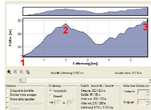
Aus der Möhne (Fluß) soll das benötigte Löschwasser über nahezu 7 km zur Einsatzstelle gefördert werden. Dabei war ein Höhenunterschied von über 300 m zu überwinden...
