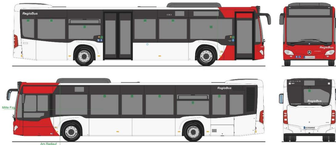
Zweifarbige Optik: Basis weiß mit verkehrsroter Front (RAL 3020). Rot läuft bis zum vorderen Radlauf und grenzt als Kreissegment an die weiße Basislackierung. Auf Front, Heck und über dem hinteren Fenstern an der Seite ist die Produktklasse z.B. „RegioBus“ aufzubringen.
